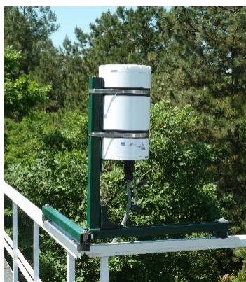
Фиг.1. Инструментът GUV 2511 на покрива на обсерваторията.
